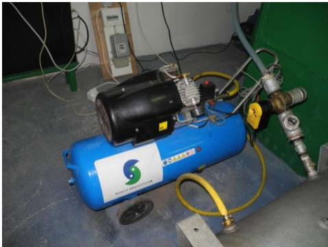
Abbildung 2 Kompressor mit Luftversorgungsschlauch
