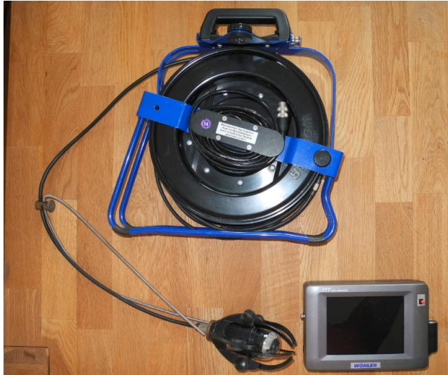
Abbildung 16 Endoskop (Monitor, Kamera, Kabelhaspel)
